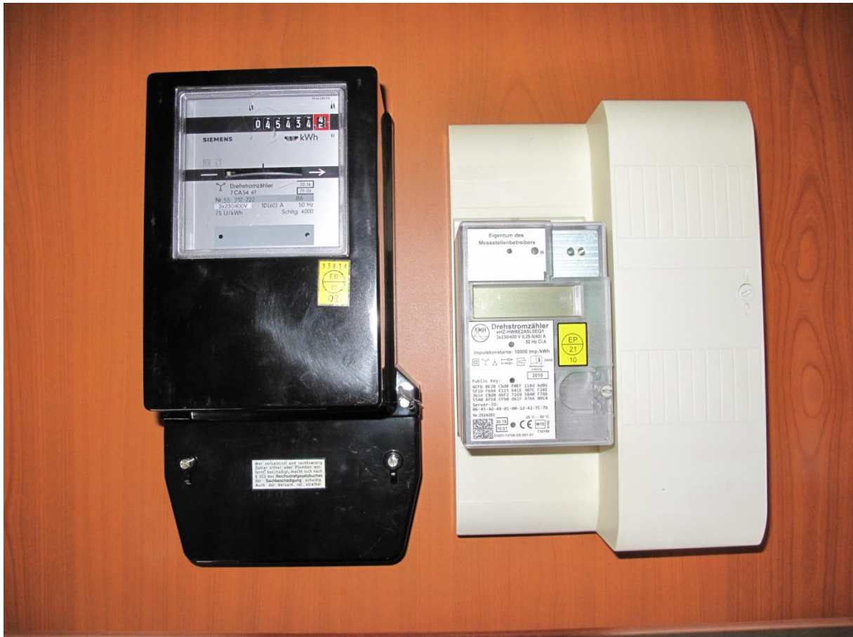
links der bisherige elektromechanische Ferraris-Zähler, rechts ein elektronischer Zähler (moderne Messeinrichtung)
